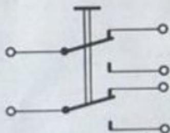
Ein solcher „2-poliger“ Umschalter wird sehr häufig als „Pol-Wendeswitcher“ zur Drehrichtungs-Umkehr von Gleichstrommotoren eingesetzt. Der fischertechnik-Schalter wurde schon im Werk entsprechend verdrahtet.
